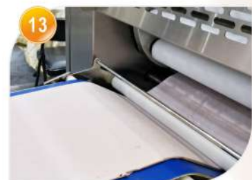
13 第二道12支行星輪壓麵 Key point kneading process (12 pcs roller design)
