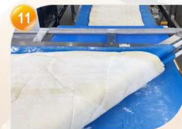
11 Z字型麵帶轉彎設計 Z type corner design
